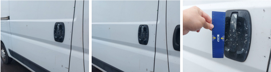
Door Rear Right / Door Handle / Replace-stain
