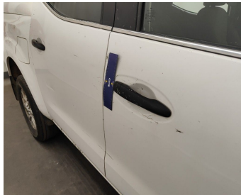
Door Front Right / Door Handle / Replace-stain
