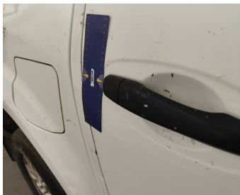
Door Rear Right / Door Handle / Replace-stain
