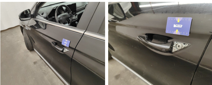
Door Front Left / Door Handle / Replace-missing
