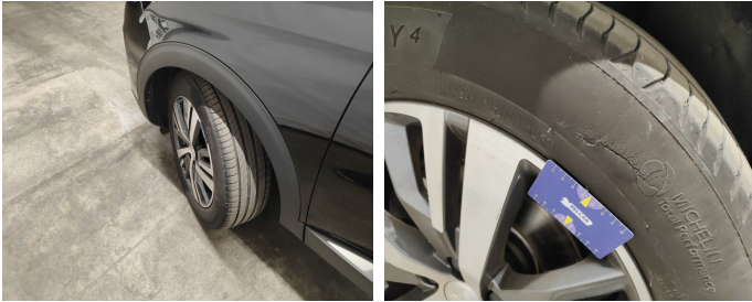
Tyre Front Left // Replace-tear
